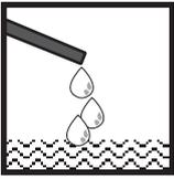
Kondensat darf nicht in das Gerät gelangen kann. Bei Minustemperaturen, durch Vereisung Fehlfunktion/Ausfall möglich.
