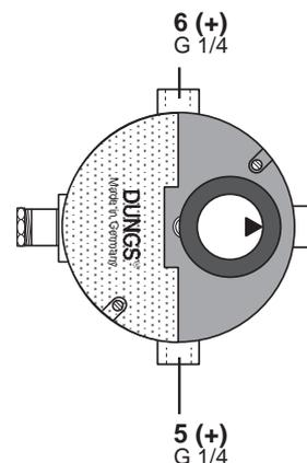
**Einbaulage / Installation position / 安装位置**
